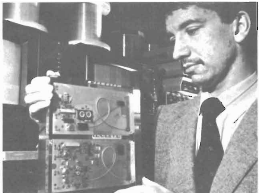
Fig. 21 - Trasmettitore Laser ed apparato ricevente d'una unità MODEM di realizzazione britannica, con la quale si coprono 100 km senza ripetitore e la B_w è tale da ammettere 2000 conversazioni telefoniche.
