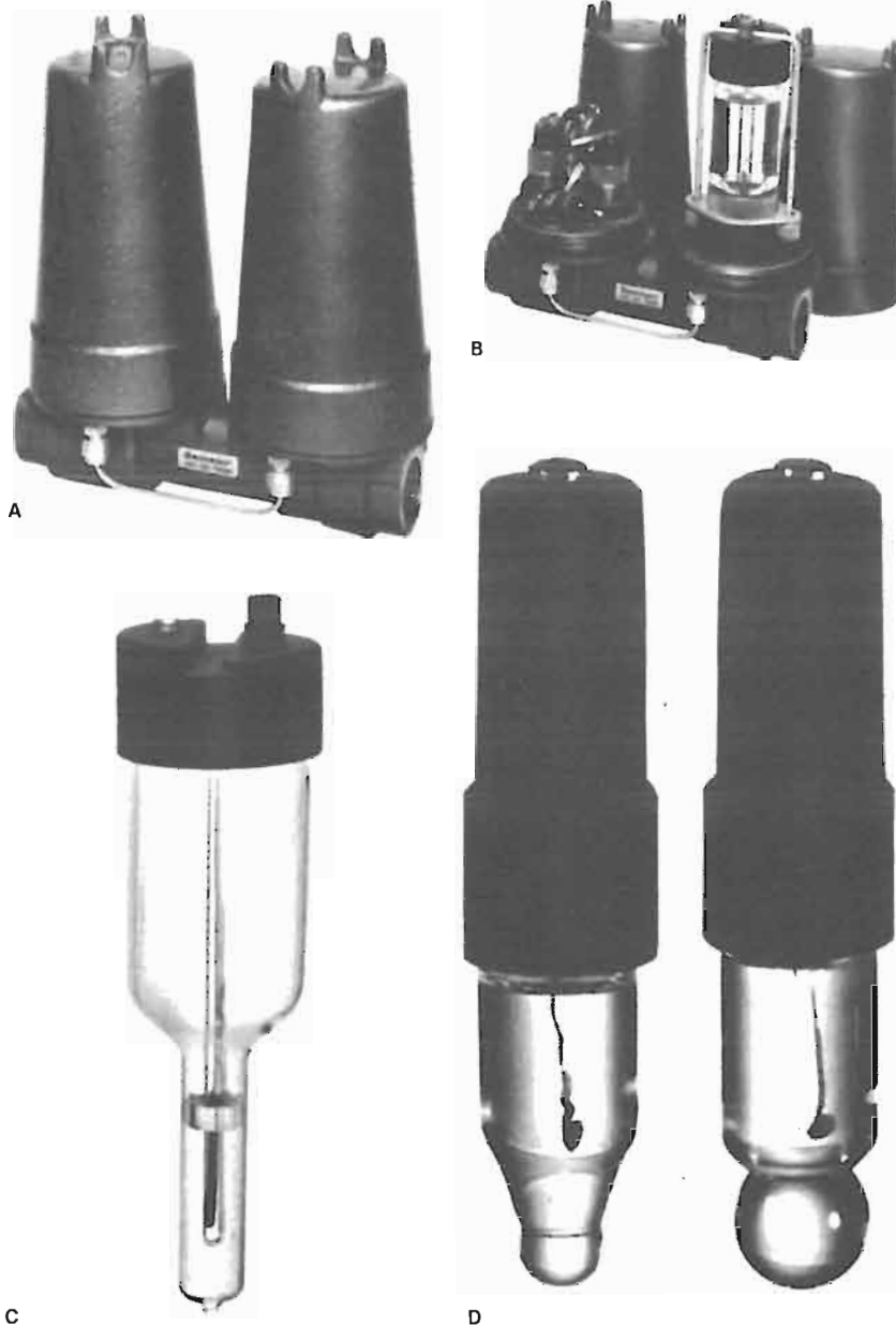
Fig. 2 - Per la misura continuativa del pH, come mezzo per migliorare e mantenere costante la qualità del prodotto, e per «un'alta efficienza di processo», la Beckman produce porta-elettrodi in contenitore resistente alle alte pressioni (A).
